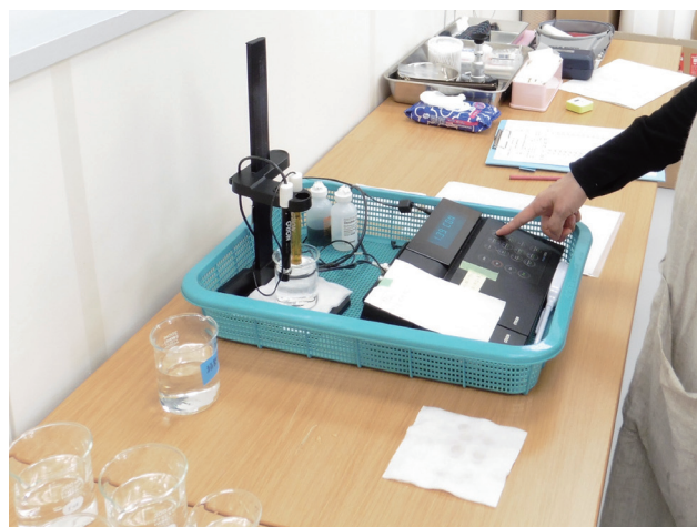
図3 ハンディイオンメータで塩化物イオン濃度を計測 Fig. 3 Measuring chloride ion concentration using a Handy Ion Meter
